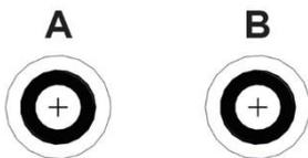
A e B: connettori automatici opzionali. Questi connettori sono usati per pilotare gli azionamenti pneumatici sul pezzo sottoposto a test.
